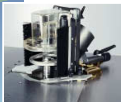
La protezione all'albero con aspirazione incorporata, fornita di serie (versione CE), permette l'esecuzione di profili su pezzi sagomati in totale sicurezza.
