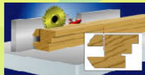
Dispositivo recupero del listello con esclusione del gruppo manuale ed esclusione pneumatica della lama. Il gruppo è compatibile con tutte le versioni toupie, incluse quelle equipaggiate con carro a tenonare.
