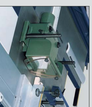
Cuffia e pianetto a tenonare Tenoning hood and tenoning table Zapfenschneidhaube- und Zapfenschneidisch Capot et table à tenoner Protector y plano para espigar
