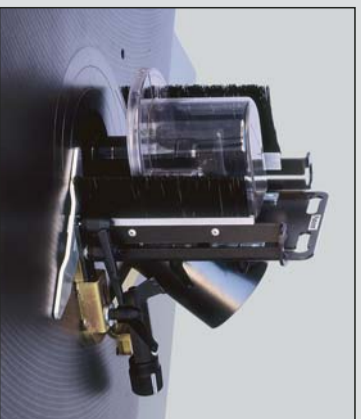
Protezione per lavorazioni all'albero toupe Protective hood for jobs on the spindle Schutz für die Bearbeitung am Antriebsring Protecteur pour travaux à l'arbre toupe Protector para trabajos en el eje tupi
