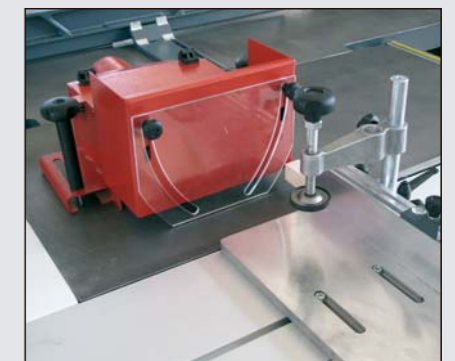
Cuffia e pianetto a tenonare Tenoning hood and tenoning table Zapfenscheidhaube und Zapfenschneidstisch Capot et table à tenonner Protector y plano para espigar
