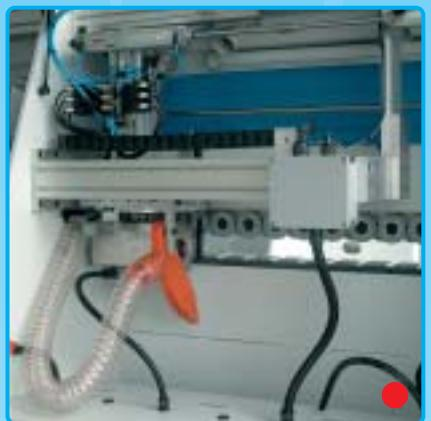
➤ **RETTIFICA** Per eliminare le eventuali imperfezioni del pannello prima della bordatura, con asportazione da 0 a 1 mm di materiale. Dotato di due motori HF montati su guide lineari e due fresa a rotazione contrapposta per ottenere un'ottima finitura, evitando scheggiature.
