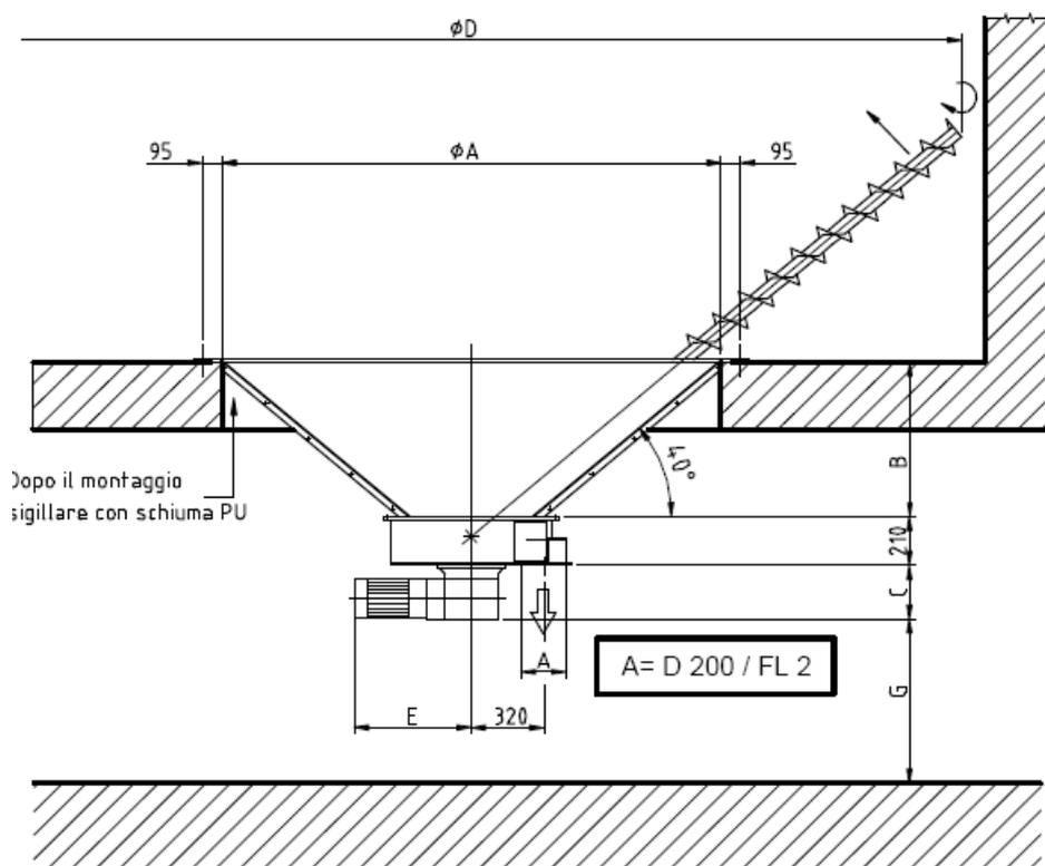
L'estrazione del materiale avviene mediante un agitatore integrato nell'alloggiamento di estrazione al cui centro viene azionata la coclea di estrazione mediante uno snodo a croce robusto. Quando il silo è pieno, la coclea tende ad assumere una posizione verticale. La tramoggia compensa la posizione obliqua della coclea quando il silo è vuoto. Comprensivo di coperchio di manutenzione con finecorsa di sicurezza in prossimità dell'uscita.
