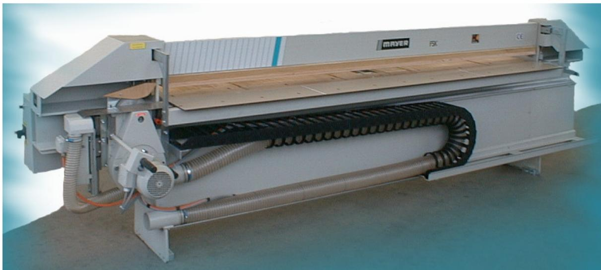
La refilatrice **FH2** è disponibile nelle lunghezze di taglio 3020, 3520 und 4200 mm. La macchina standard è dotata per il carro sega di guide di alta precisione del tipo lineari e tubo d'aspirazione del tipo a cingolo per essere collegata all'impianto centralizzato del cliente. Come optional sono disponibili: gruppo pialla, piano aggiunto anteriore, piano posteriore con visore digitale con letture con banda magnetica.
