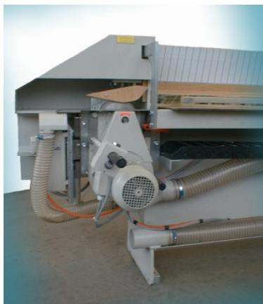
Il gruppo pialla per il ripassaggio dell'impiallacciatura tagliata con il guppo sega ha uno spostamento verticale pneumatico con guide di alta precisione del tipo lineari. Il gruppo pialla si riposiziona automaticamente nella posizione iniziale (posizione verticale) allo spegnimento dei motori. Con il gruppo pialla si riescono a garantire tagli perfetti anche su impiallacciati particolarmente difficili come quercia e impiallacciati molto secchi.
