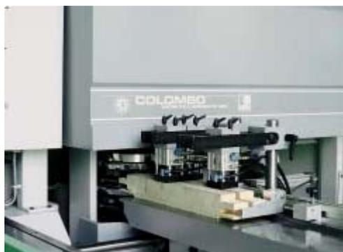
Tenonare con 2 utensili possibile in una sola operazione.
