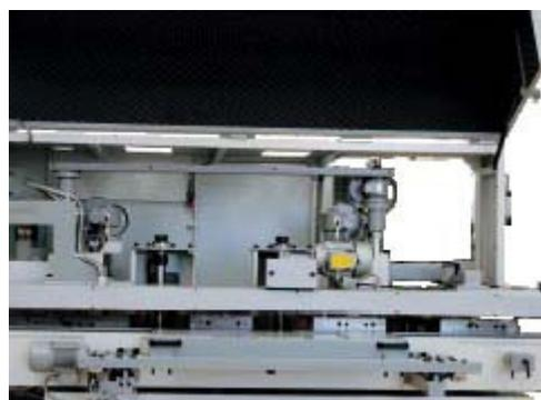
Squadra sinistra della profilatrice con posizionamento verticale e orizzontale ad asse continuo da CNC.
