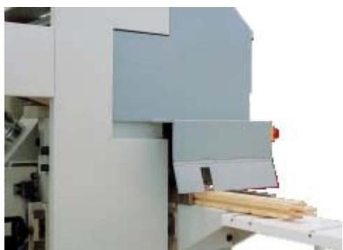
Profilatura del quadrotto con utensili a posizionamento degli assi a controllo numerico.
