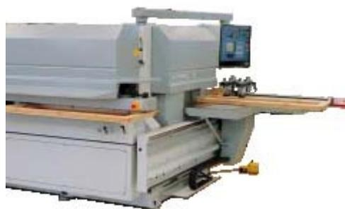
Sbattentura dell'anta sulla tenonatrice e successivo passaggio alla profilatura sulla profilatrice.
