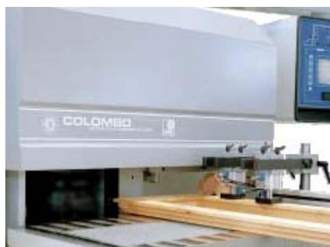
Sbattentatura dell'anta sul carro a tenonare.
