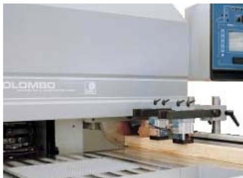
Intestatura a controllo numerico: la riga programmata permette di posizionare la battuta sulla riga automaticamente. Inoltre il posizionamento numerico del gruppo sega permette di realizzare tenoni con profondità diverse.
