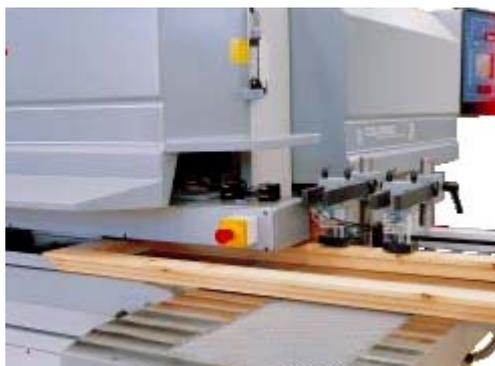
Dopo la tenonatura la finestra raggiunge la profilatrice in automatico.
