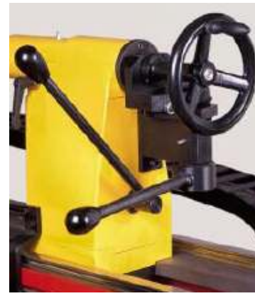
Dispositivo fissaggio rapido sul controsupporto
