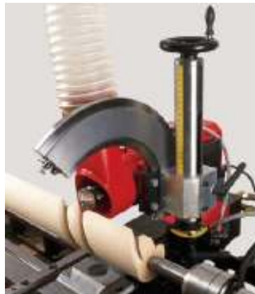
Gruppo fresa con testa fresa impostata orizzontale
