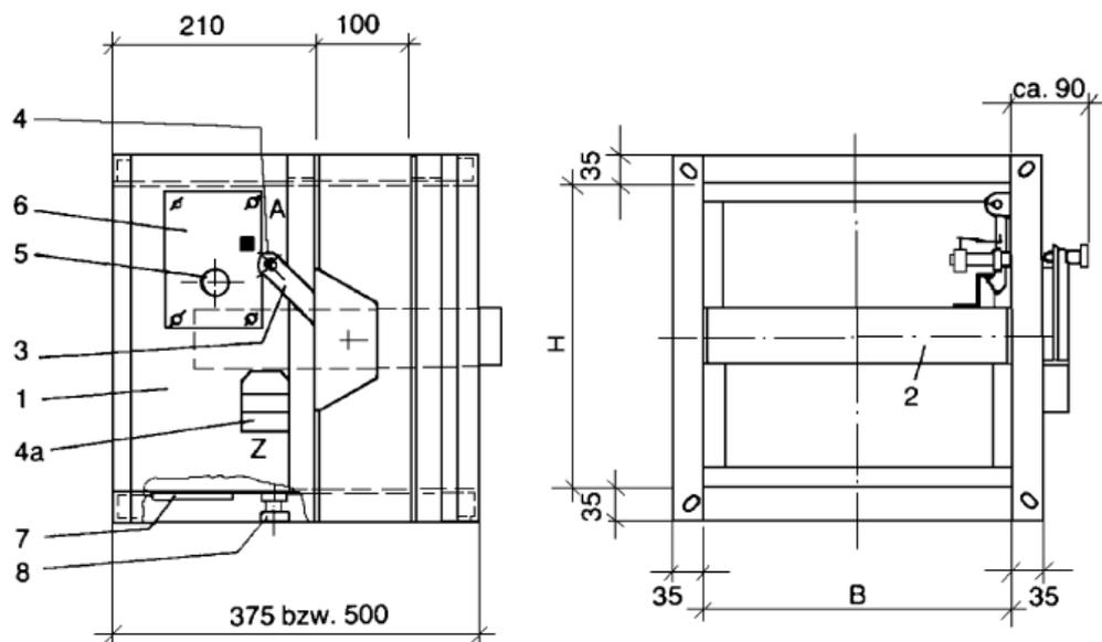
Le serrande tagliafuoco vengono impiegate per l'installazione all'interno dei circuiti di ventilazione con la funzione di bloccaggio di settori di canalizzazioni circolari in caso di incendio. Il montaggio delle serrande viene effettuato con l'otturatore in allineamento al muro o al condotto tagliafuoco.
