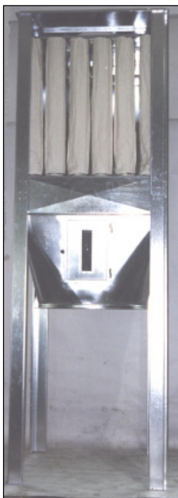
Filtro a maniche impiegato per l'aspirazione e la filtrazione di trucioli e polveri di legno.
