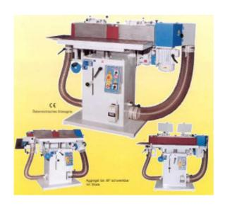
Type KSM O I S mit aufklappbarer Furnierkanten-Schleifeinrichtung Schleifband oszillierend
