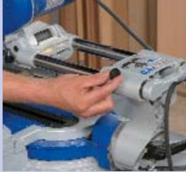
Die mehrfach gelagerte Zugeinrichtung garantiert exakte Schnitte und kann in jeder gewünschten Position festgestellt werden. Von Vorteil bei Schnitten, bei denen die Zugeinrichtung nicht benötigt wird oder beim Transport der KGS 303.
