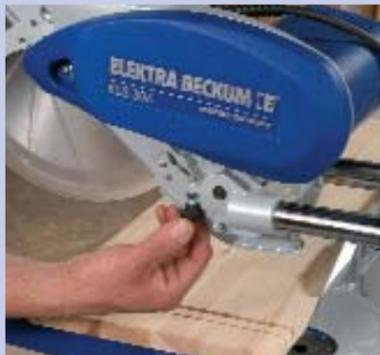
Durch die integrierte Schnitttiefeinstellung ist die Herstellung von Quernuten möglich. Einfaches Wechseln des Sägeblattes durch die Sägeblatt-Arretierung. Durch Betätigung wird die Sägeblattwelle festgestellt und das Sägeblatt kann mit dem an der Maschine deponierten Werkzeug gewechselt werden.
