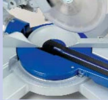
Über die exakte Gradskala lässt sich der Drehteller stufenlos nach links bis 50° und nach rechts bis 60° verstellen. Alle gängigen Winkelpositionen sind mit einer Einrastfunktion ausgestattet.
