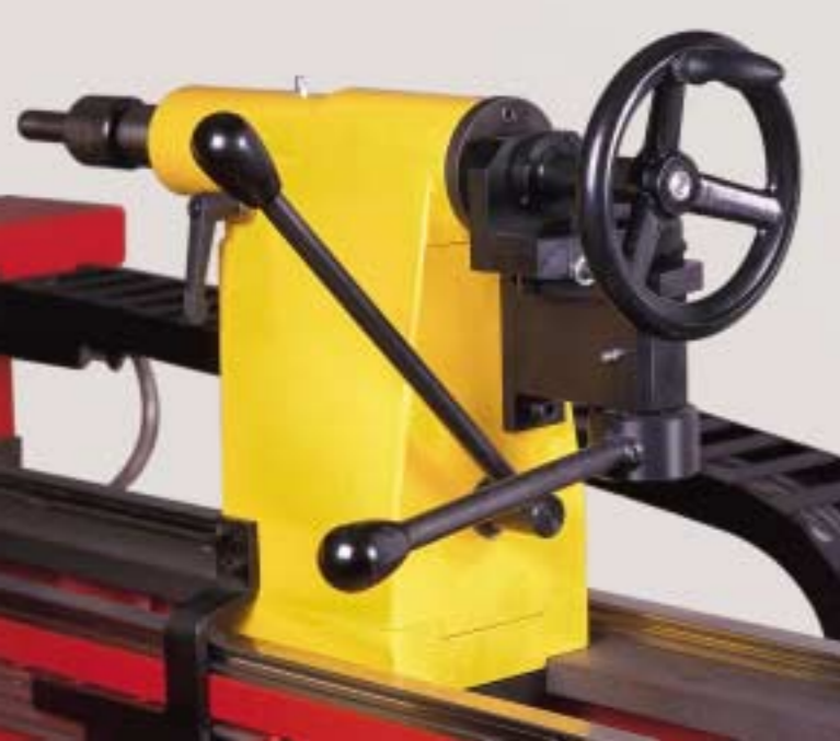
Reitstock-Schnellspannung Quick loading device Serrage rapide a excentrique
