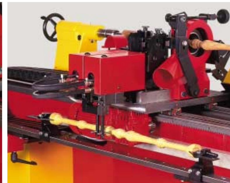
Profilablastung vom Muster copying from original copiage sur modèle
