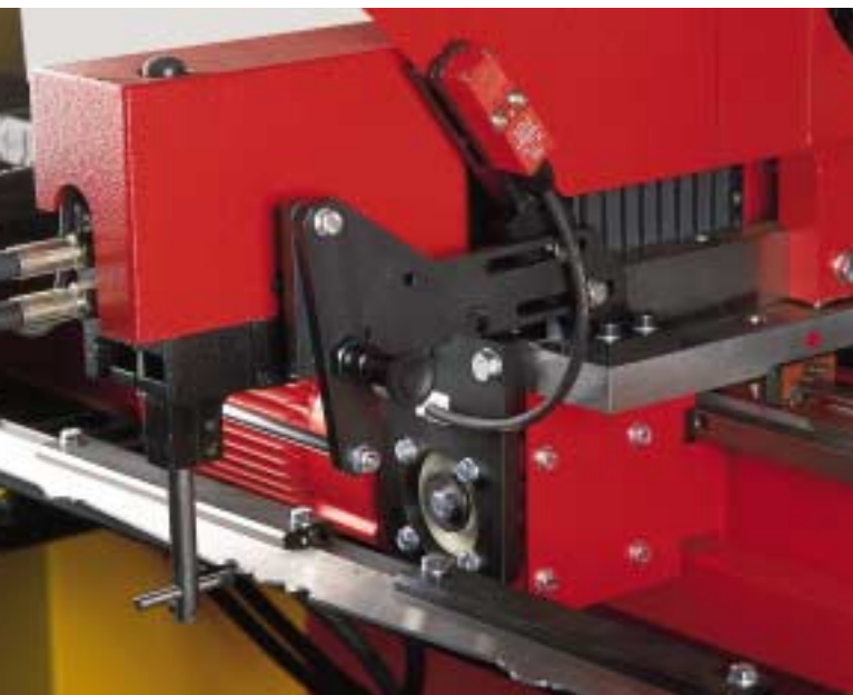
Profilablastung von der Schablone copying from template copiage sur gabarit
