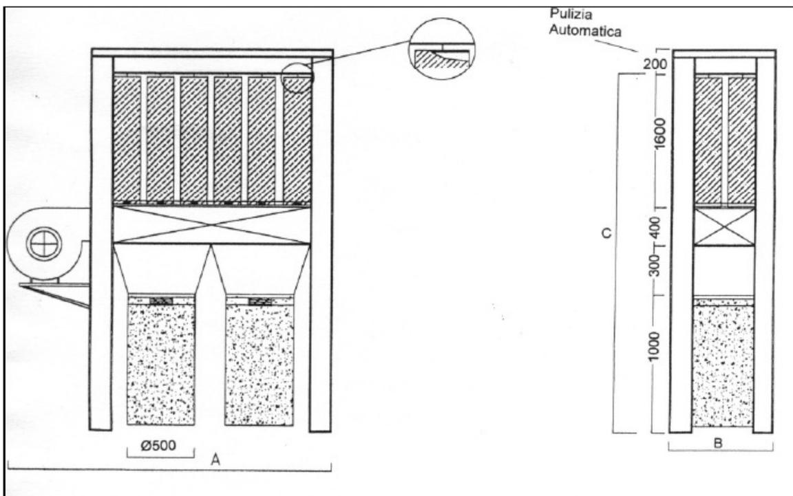
Die Filtereinheit besteht aus Filterplatte, Filterschläuchen und Vorabscheidkammer. Die Wahl des Filtermaterials ist abhängig vom Fördergut sowie von der Abluft- bzw. Fortluftführung.
